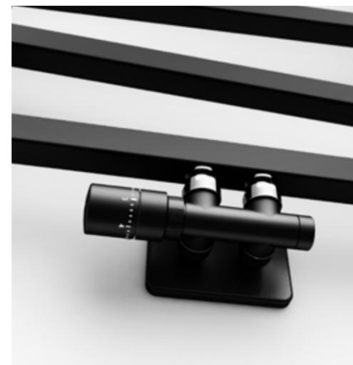
Molti termo arredi vengono preparati e venduti con gli attacchi a interasse fisso 50 mm che permettono di posizionare i tubi di ingresso e di uscita dell'acqua senza essere vincolati dalle dimensioni del radiatore in quanto l'attacco rimane uguale per ogni altezza e larghezza. Il portare i tubi alla stessa altezza, in un'unica posizione mantenendo la distanza di 50 mm
